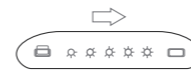
Wanneer een open signaal wordt ontvangen, gaan de indicatielampjes beurteelings van links naar rechts branden.
