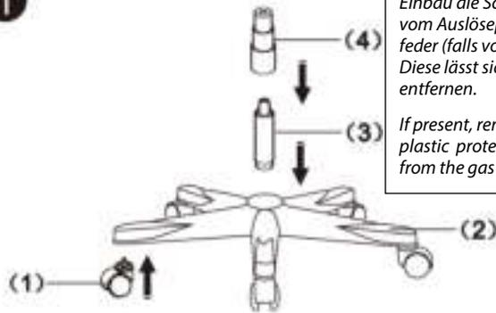
Entfernen Sie vor dem Einbau die Schutzkappe vom Auslösepipin der Gasfeder (falls vorhanden). Diese lässt sich leicht entfernen.
