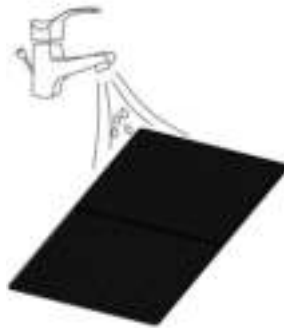
Foto 2: Spoel het filter onder stromend water.
