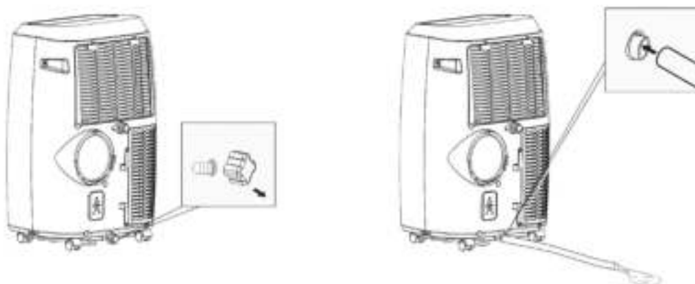
Figure 7 Écoulement de la cuve de sol
