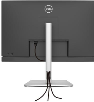
Dopo avere collegato tutti i cavi necessari al monitor ed al computer (fare riferimento alla sezione [Collegamento del monitor](#) per il collegamento dei cavi), organizzare tutti i cavi come mostrato sopra.
