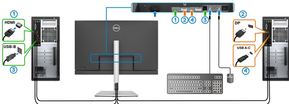
**NOTA: Il collegamento USB Type-C (USB tipo C) attualmente supporta solo il trasferimento dei dati.**
