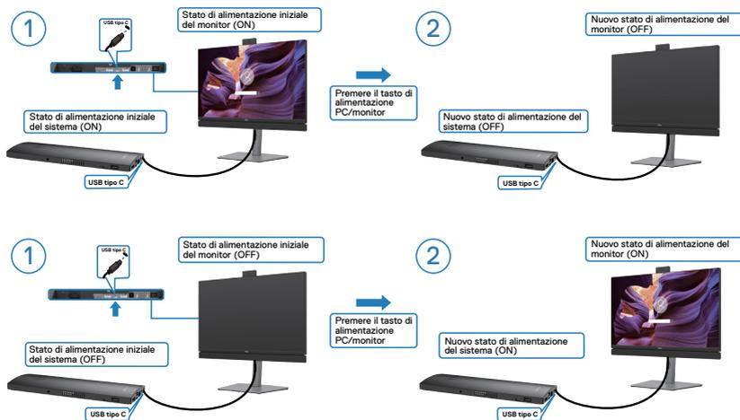
Quando lo stato di alimentazione del monitor e del PC è su ON, mentre si tiene premuto per 4 secondi il tasto di alimentazione del monitor, sullo schermo appare il messaggio che richiede se si desidera spegnere il PC.
