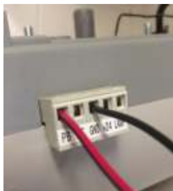
De binnenschakelaar met draad of sleutelschakelaar op PB en GND
