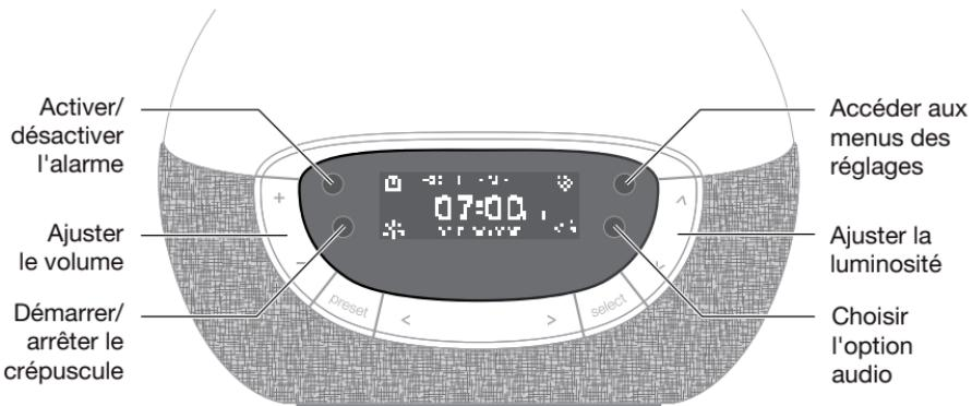
Les quatre boutons noirs exécutent des fonctions spécifiques indiquées par l'icône située à côté. L'icône inférieure droite indique quelle option audio est en cours d'utilisation.
