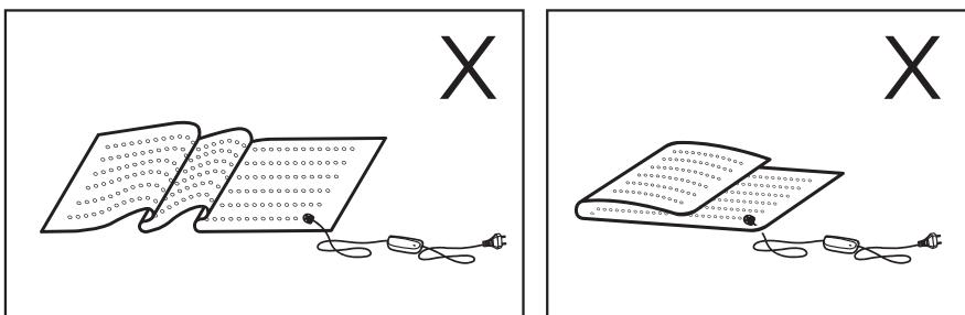
De elektronische onderdelen in de schakelaar kunnen warm worden als het product aan staat. Daarom dient de schakelaar niet afgedekt te worden of geplaatst te worden bovenop een in gebruik zijnde andere verwarmingsbron.
