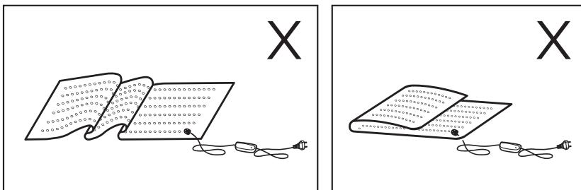
En raison de ses composants, le contrôleur peut légèrement chauffer; ne le recouvrez donc jamais et ne le placez pas sur le produit ou sur un oreiller, et ne vous couchez pas sur la résistance du matelas électrique.
