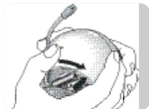
**3** Riponete il coperchio (A-12) del vano batterie in posizione. Chiudete il vano batterie girando il coperchio (A-12) verso destra (CLOSE ▶), usando il palmo della mano.
