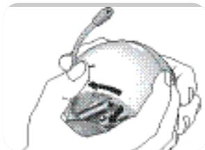
**2** Coloque cuatro pilas AA de 1.5V, observando la configuración + y - en el interior del compartimiento de las pilas (las pilas no se suministran; recomendamos pilas alcalinas Philips).
