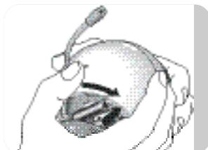
3 Sett batteriromdekselet (A-12) på plass igjen. Lukk batterirommet ved å dreie dekselet (A-12) til høyre (CLOSE ▶) med håndflaten.
