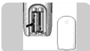
**3** Volte a colocar a tampa (B-12) no compartimento. Feche o compartimento fazendo deslizar a respectiva tampa (B-12) para cima até encaixar com um clique.
