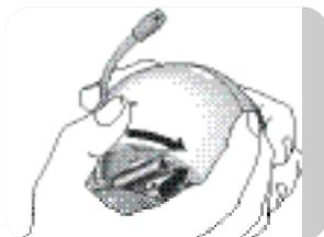
**3** Aseta paristolokeron kansi (A-12) takaisin paikalleen. Sulje paristolokero kääntämällä kantta (A-12) oikealle (CLOSE▶) käyttämällä kämmentä.
