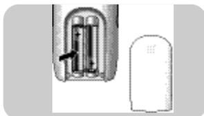
**3** Remplacez le couvercle du compartiment des piles (B-12). Fermez le compartiment en faisant glisser le couvercle (B-12) vers le haut jusqu'à ce qu'il s'enclenche.
