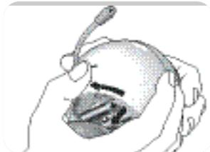
2 Lägg i fyra 1,5 V-batterier av AA-storlek. Se till att de kommer åt rätt håll, se + och - inuti batterifacket. (Batterier medföljer inte. Vi rekommenderar alkaliska batterier från Philips).
