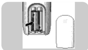
3 Sätt tillbaka locket till batterifacket (B-12). Stäng facket genom att skjuta locket (B-12) uppåt tills det knäpps fast.
