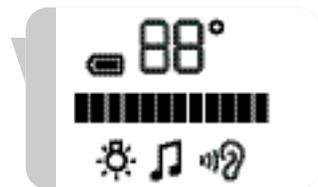
*H 19h* - Η θερμοκρασία δωματίου είναι υψηλότερη από τη θερμοκρασία που έχει ρυθμιστεί στο μενού
