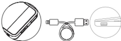
Schließen Sie die Powerbank über den USB-Port, mit dem mitgelieferten USB- auf Micro-USB-Kabel, an Ihren Computer an.
