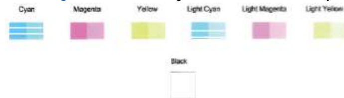
Afbeelding 9-2 Voorbeeld van gekleurde blokken met afwijkingen
