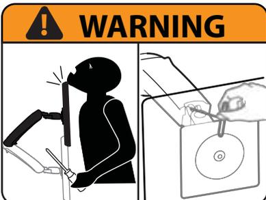
**WARNING!** Gefährdung durch gespeicherte Energie: Der Arm-Mechanismus der Arbeitsfläche steht unter Spannung und bewegt sich von allein und schnell nach oben, sobald das befestigte Gerät abgenommen wird. Entfernen Sie aus diesem Grund die Geräte nur, wenn sich der Arm auf der höchsten Position befindet! Eine Missachtung dieser Anweisung kann zu ernsthaften Verletzungen und/oder Beschädigungen am Gerät führen.
