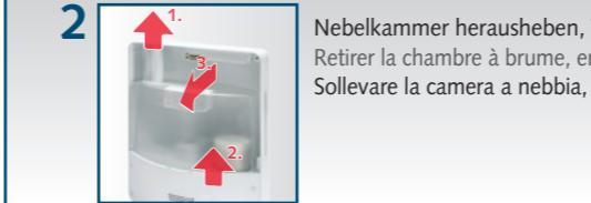
Nebelkammer herausheben, Tank entnehmen
