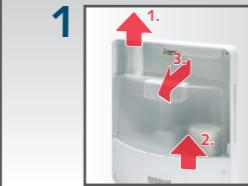
Nebelkammer herausheben, Tank entnehmen
