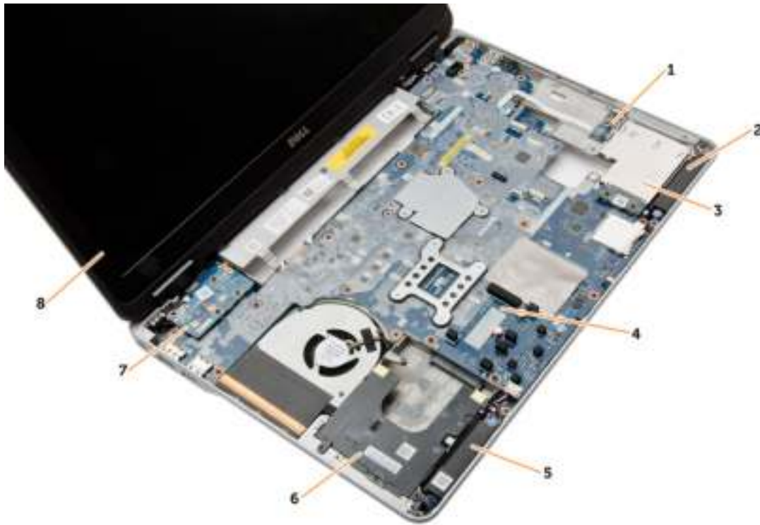
Afbeelding 2. Bovenaanzicht: toetsenbord en polssteun verwijderd
