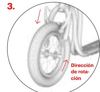
Inserte la rueda en la horquilla delantera de tal manera que quede exactamente en el medio. **Precaución:** Cuando inserte la rueda, asegúrese que la flecha en la banda de rodadura del neumático apunte en la dirección de rotación cuando el patinete se desplace hacia delante.
