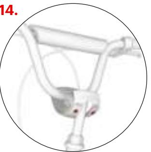
Kontrollige, et piduriklotsid eemalduks pidurihoova vabastamisel veljest piisavalt (1-2 mm). Piduriklotside kaugust saab muuta ankrupoldiga piduritrossi pingutamise või lõdvendamise teel (1). Kui piduriklotsid puutuvad ratta põõrlemise ajal velje vastu, siis reguleerige pidurivarte kaugust pingutamispoltidega (2) sümmeetriliselt.
