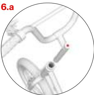
Sätt in spindeln i ramrörte av skoter och justera styrets höjd noga, och inte placera den ovanför den markerade raden, se bild. 6b. Se till att styret är raka och sedan dra åt skruven på spindeln.
