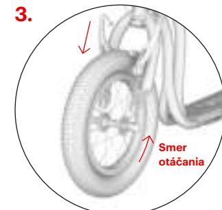
Inserire la ruota nella forcella anteriore e centrarla. **Attenzione:** il battistrada dovrebbe essere orientato in avanti seguendo il senso di marcia (vedi la freccia del senso di rotazione sul lato del copertone).
