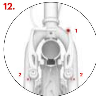
Controllare se quando si rilascia la leva del freno i pattini si allontanano sufficientemente dal cerchione (1-2 mm). La distanza tra i pattini può essere regolata tendendo oppure allentando il cavo del freno sul bullone di ancoraggio (1). Se girando, la ruota tocca i pattini del freno, regolare simmetricamente la distanza dei due bracci del freno con l'aiuto delle viti di fissaggio (2).
