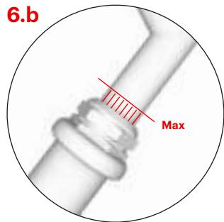
Die maximale Höhe des Lenkers ist durch vertikale Linien markiert, diese sollten bei Einstellung auf maximale Höhe nur teilweise sichtbar sein.
