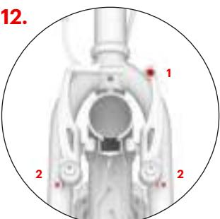
Skontrolujte, či sa doštičky pri uvoľnení brzdovej páčky dostatočne oddialia od ráfika (1-2 mm). Vzdialenosť doštičiek sa dá upraviť pritiahaním či povolením brzdového lanka v kotevnej skrute (1). Pokiaľ sa koleso pri otáčaní v niektorom mieste dotýka brzdových doštičiek, symetricky upravte vzdialenosť brzdových ramien napínačimi skrutkami (2).
