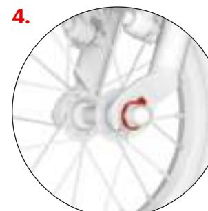
Stellen Sie sicher, dass der Schnabel der Unterlage an der richtigen Stelle eingerastet ist und ziehen Sie dann beide Muttern fest.
