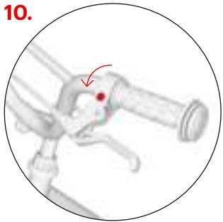
**Regolazione dell'inclinazione delle leve del freno**
