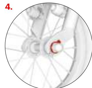
Убедитесь, что выступ шайбы попал в нужное отверстие и тогда затяните обе гайки.
