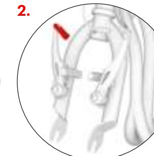
Stellen Sie sicher, dass die vordere Gabel des Rollers in die korrekte Richtung gedreht ist (die Arme der V-Bremse zeigen nach vorne) und nehmen Sie das Bremskabel aus dem Bremszug.
