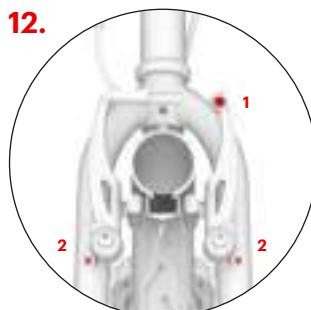
Проверьте, чтобы при отпускании ручки тормоза колодки достаточно отдалились от обода (1–2 мм). Расстояние между колодками и ободом можно настроить, прижав или ослабив тормозной трос в крепёжном болте (1). Если колесо при вращении в каком-либо месте трётся о тормозную колодку, измените симметрично расстояние до рычагов тормоза с помощью натяжных болтиков (2).
