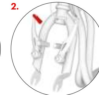
Проверьте, повернута ли передняя вилка в правильном направлении (рычаги ободного тормоза находятся впереди), затем ослабьте тормозной трос в хомуте.
