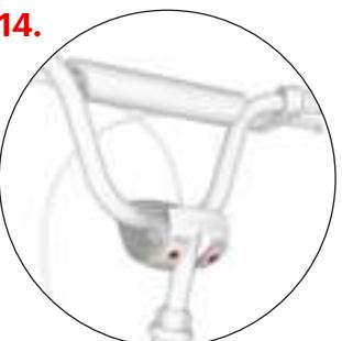
Sprawdź, czy klocki hamulcowe odsuwają się od obręczy w dostatecznym stopniu (1-2 mm), kiedy dźwignia hamulca zostanie zwolniona. Odległość klocków hamulcowych można regulować poprzez dokręcenie lub poluzowanie śruby mocującej linkę hamulca (1). Jeśli klocki hamulcowe wchodzą w kontakt z obręczą w czasie, kiedy kółko się obraca, ustaw odstępy ramion hamulców symetrycznie za pomocą śrub regulujących (2).
