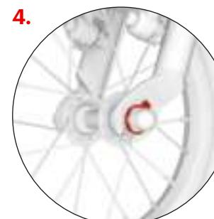
Uistite sa, že zobáčik podložky zapadol do správneho otvoru a potom dotiahnite obidve matice.
