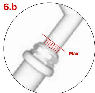
Максимальная высота руля обозначена вертикальными канавками, которые в наивысшем положении должны быть видны только частично.
