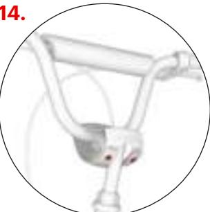
Zkontrolujte, zda se špalíky při uvolnění brzdové páčky dostatečně oddálí od ráfku (1–2 mm). Vzdálenost špalíků lze upravit přítažením či povolením brzdového lanka v kotevním šroubu (1). Pokud kolo při otáčení v některém místě škrátá o brzdový špalík, symetricky upravte vzdálenost brzdových rámů napínacími šroubkami (2).
