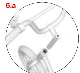
Stecken Sie den Anbau in die Rahmenröhre des Rollers und stellen Sie die gewünschte Lenkerhöhe ein, max. bis zur Markierung, siehe Abb. 6.b. Stellen Sie sicher, dass der Lenker gerade ist (senkrecht zur Achse des Rades) und ziehen Sie die Schraube am Anbau fest.
