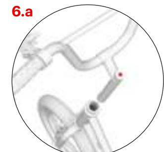
Inserte el vástago en el tubo del bastidor del patinete y ajuste la altura del manillar teniendo cuidado de no situarlo por encima de la línea marcada, véase img. 6b. Asegúrese que el manillar está recto y luego apriete el tornillo en el vástago.
