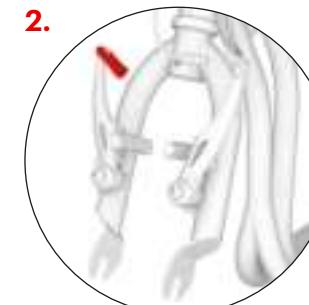
Primero verifique que la horquilla delantera del patinete está correctamente alineada (los brazos del freno en V deben apuntar hacia adelante, hacia la parte frontal del patinete), luego suelte el cable del freno de la guía.
