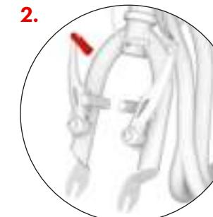
Skontrolujte, či je predná vidlica kolobežky natočená v správnom smere (ramená V-brzdy smerujú dopredu) a uvolnite brzdové lanko z vodítka.
