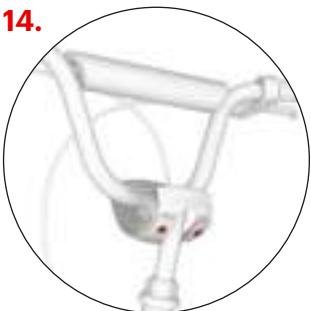
Vérifiez si les patins s'écartent suffisamment de la jante (1-2 mm) lors de la libération de la manette de frein. La distance des patins peut être ajustée en resserrant ou en desserrant le boulon d'ancrage du câble de frein (1). Si la roue en tournant entre en contact avec le patin de frein, ajustez de manière symétrique la distance des bras de frein à l'aide des vis de tension (2).
