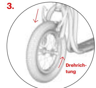
Setzen Sie nun das Rad in die Vordergabel ein. Es sollte sich genau in deren Mitte befinden. **Vorsicht!** Das Reifenprofil sollte in Fahrtrichtung nach vorne zeigen, siehe den Pfeil an der Seite des Reifenmantels.
