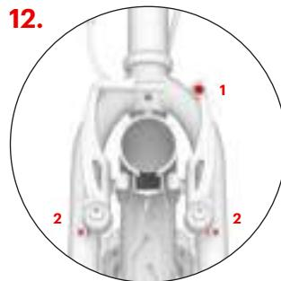
Stellen Sie sicher, dass der Abstand der Bremsbeläge von der Felge bei unbetätigtem Bremshebel etwa 1-2 mm beträgt. Der Abstand der Bremsbeläge kann durch das Festziehen bzw. Lockern des Bremsseils in der Fixierschraube reguliert werden (1). Falls der Reifen beim Drehen an irgendeiner Stelle streift, stellen Sie die Entfernung der Bremssarme durch die Spannschrauben (2) symmetrisch ein.
