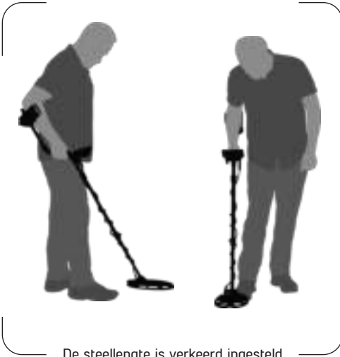
De steellengte is verkeerd ingesteld
