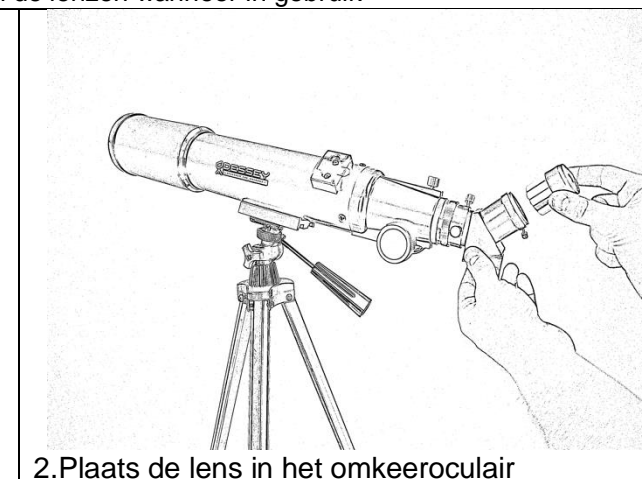
1. Plaats het omkeerooculair in de telescoop
