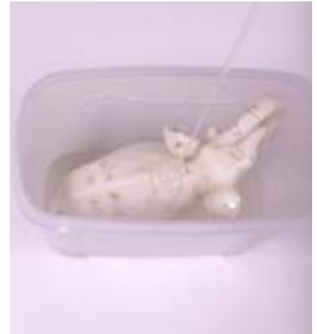
Fig. 3: Met een dunne straal worden de siliconen gegoten tot een eerste laag van +/- 4 cm. Na 3 uur wordt de mal volledig afgegoten. Dit zodat het (holle) model “zeker” niet gaat drijven.
