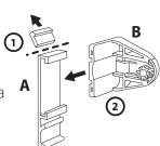
3. Percer la pièce A Ø5 mm à travers les lumières de la pièce B
