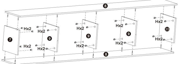
Beim Einbau des Teils Nr. 7 müssen die beiden Bohrungen wie in der Abbildung oben rechts angezeigt sein. When installing No. 7, the two pilot holes should be on the upper right as shown in the figure
