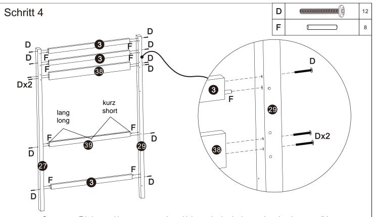
Component F is inserted into component 3, and it is required to be inserted as deeply as possible Komponente F wird in Komponente 3 eingefügt und muss so tief wie m?glich eingefügt werden
