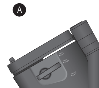
Placer le loquet en position Ranger pour le ranger
