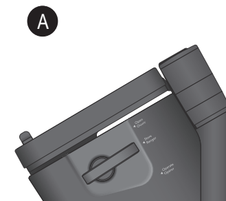
Sítue el pestillo en la posición de Almacenamiento para almacenar la unidad.
