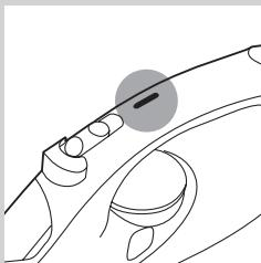
De veilige automatische uitschakelfunctie schakelt het strijkijzer automatisch uit wanneer het langer dan 30 seconden niet wordt gebruikt terwijl het op de zoolplaat staat of langer dan 8 minuten niet wordt gebruikt terwijl het op de achterplaat staat. Het lampje voor de automatische uitschakelfunctie gaat branden.
