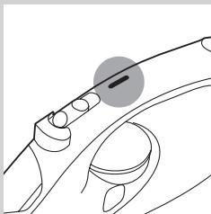
La fonction d'arrêt automatique éteint le fer s'il n'a pas été utilisé pendant 30 secondes et posé sur sa semelle ou pendant 8 minutes et posé sur son talon. Le voyant d'arrêt automatique s'allume.
