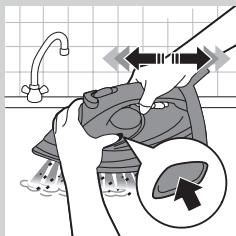
*Opmerking: herhaal stappen 2 tot 5 als het water dat uit het strijkijzer komt nog steeds kalkdeeltjes bevat.*
