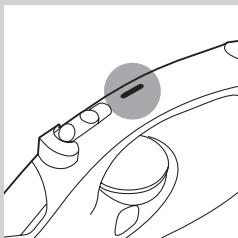
Mit der Funktion zur automatischen Sicherheitsabschaltung wird Ihr Bügeleisen automatisch ausgeschaltet, wenn es 30 Sekunden lang auf der Bügelsohle oder 8 Minuten lang in aufrechter Position abgestellt wurde. Die Anzeige für die automatische Sicherheitsabschaltung leuchtet auf.
