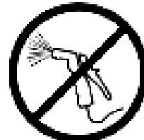
**! WICHTIG !** Verwenden Sie NIEMALS einen Wasserschlauch oder jegliche andere Flüssigkeit zum Reinigen der Unterseite des Mähers. Flüssigkeiten können einzelne Komponenten des Mähers beschädigen.
