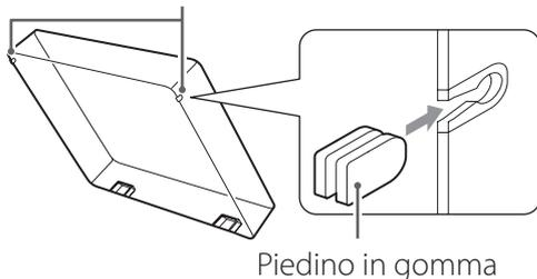
Come mostrato nella figura, fissare i piedini in gomma ai lati sinistro e destro del coperchio giradischi.
