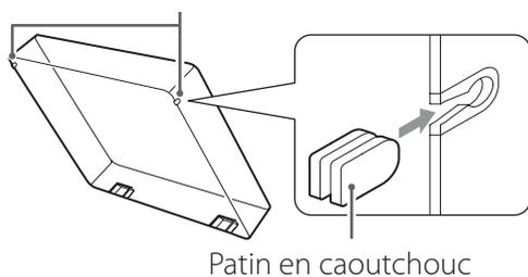
Comme représenté dans l'illustration, montez les patins en caoutchouc sur les côtés gauche et droit du couvercle de la platine.
