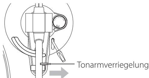
**3** Heben Sie den Tonarm mithilfe des Tonarmlifts an und schieben Sie ihn ein wenig nach links.
