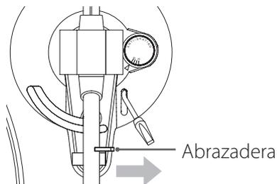
**3** Levante la palanca de altura y desplace el brazo ligeramente hacia la izquierda.
