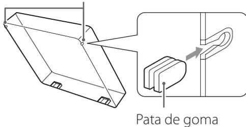
Como se muestra en la ilustración, encaje las patas de goma en los laterales izquierdo y derecho de la tapa del plato giradiscos.
