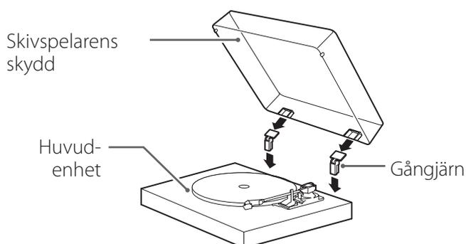
**1** Sätt gångjärn komplett i gångjärnhållarna på vänster och höger slut av huvudenhetens baksida.
