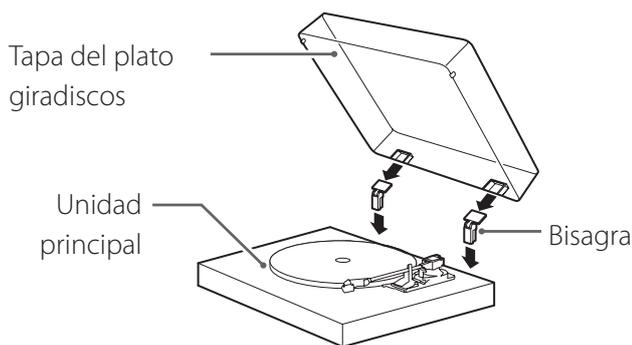
**1** Inserte las bisagras por completo en las sujeciones situadas en los extremos izquierdo y derecho de la parte posterior de la unidad principal.
