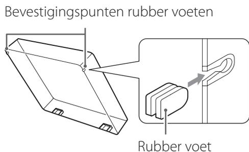
Bevestig de rubber voeten aan de linker- en rechterkant van de draaitafel, zoals in de illustratie wordt weergegeven.
