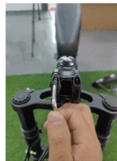
Draai de schroeven los en verwijder het deksel
