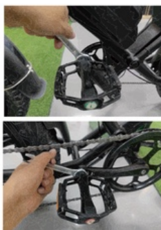
Monteer het pedaal en draai de schroef vast
