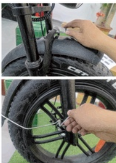
Monteer het spatbord en draai alle schroeven vast
