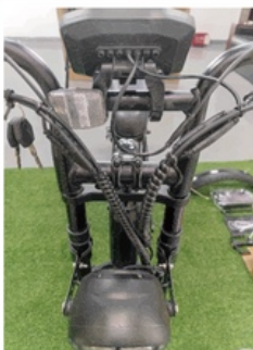
Monteer de voorkant en draai alle schroeven vast
