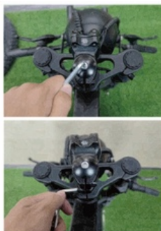
Installeer de houder en het bovendeksel en draai alle schroeven vast
