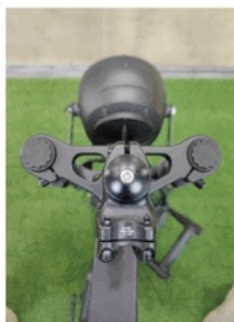
Gebruik de M5 inbussleutel om de schroef los te schroeven
