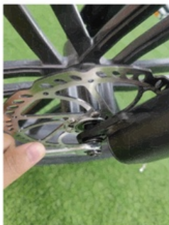
Draai de schroeven aan beide zijden vast
