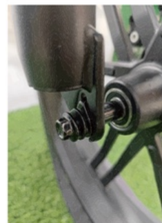
Installeer de wielen en let op de volgorde van de accessoires
