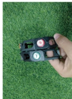
R voor rechterpedaal en L voor linkerpedaal
