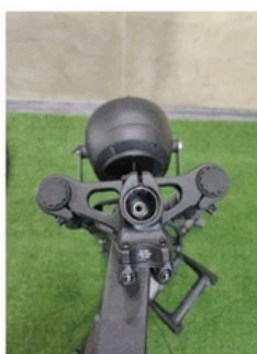
Draai de schroef los en verwijder de sierkap
