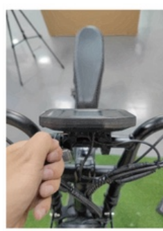
Monteer het dashboard en draai alle schroeven vast
