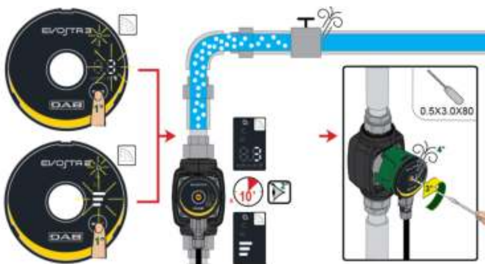
8 pav.: Oro išleidimas iš siurblio
