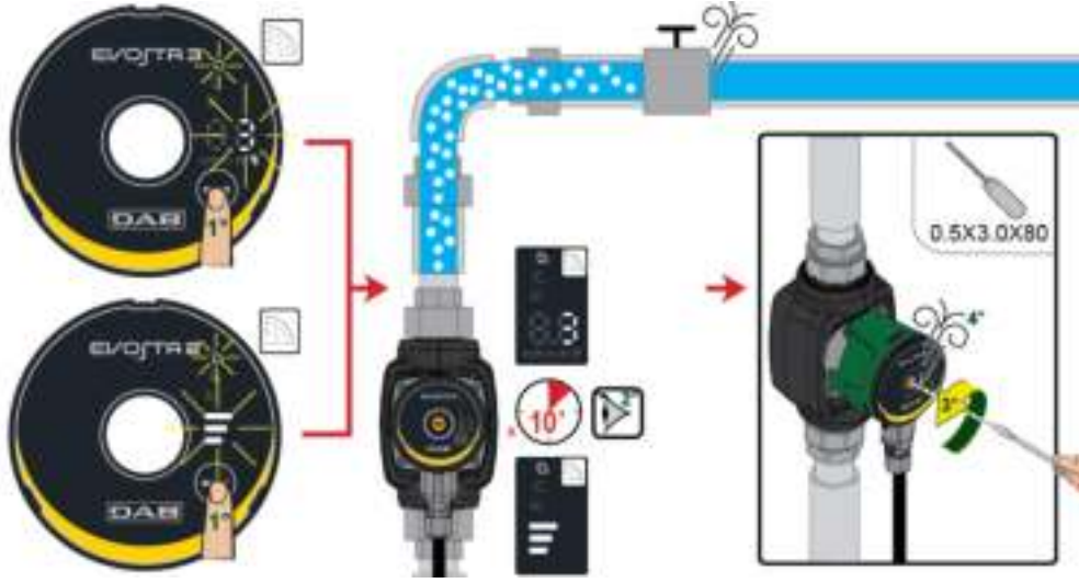
Resim 8: Pompanın havasını boşaltma
