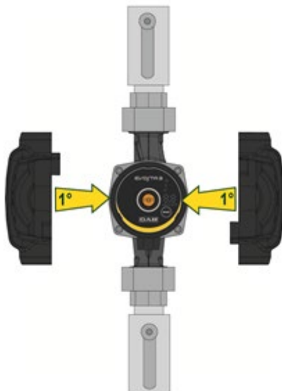
Obrázek 7: Izolace tělesa čerpadla
