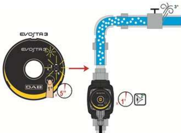
Figura 9: Aerisirea automată a pompei
