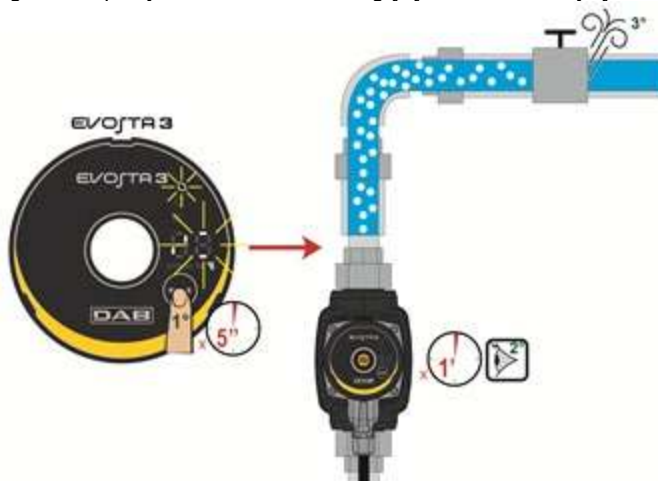
9 pav.: Automatinis oro išleidimas iš siurblio
