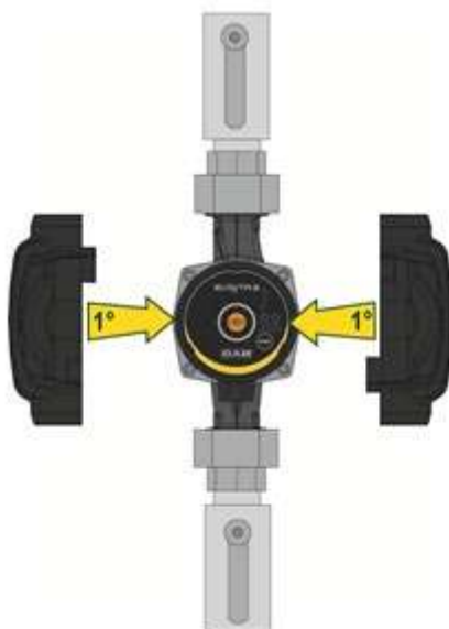
Slika 7: Izolacija ohišja črpalke
