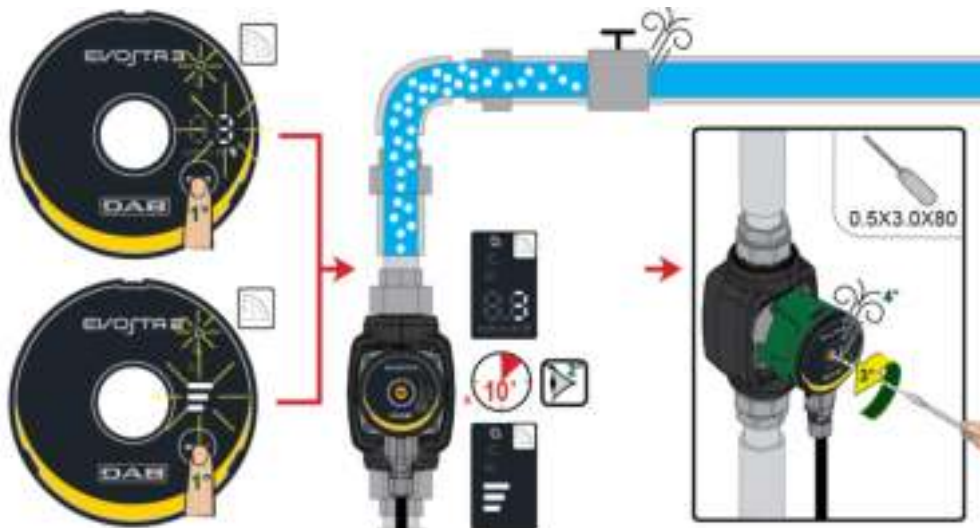
Фигура 8: Обезвъздушаване на помпата
