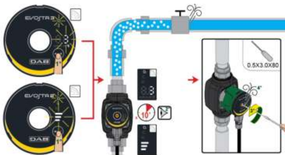
Figura 8: Purga de la bomba
