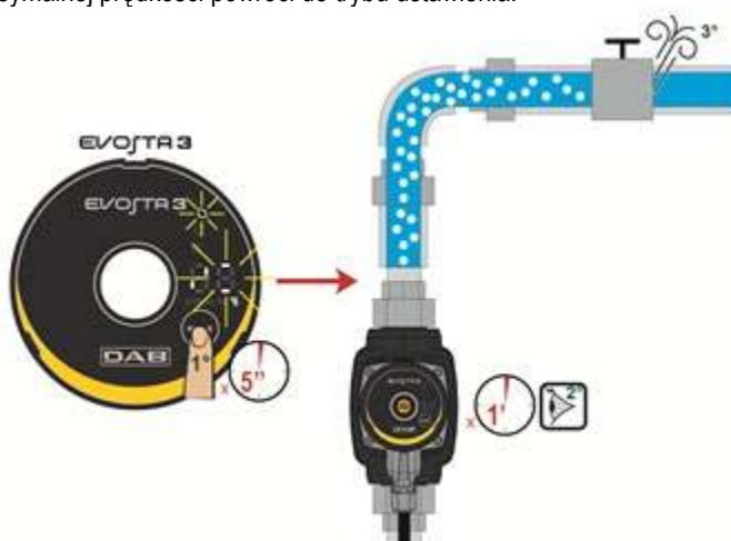
Rysunek 9: Automatyczne odgazowanie pompy
