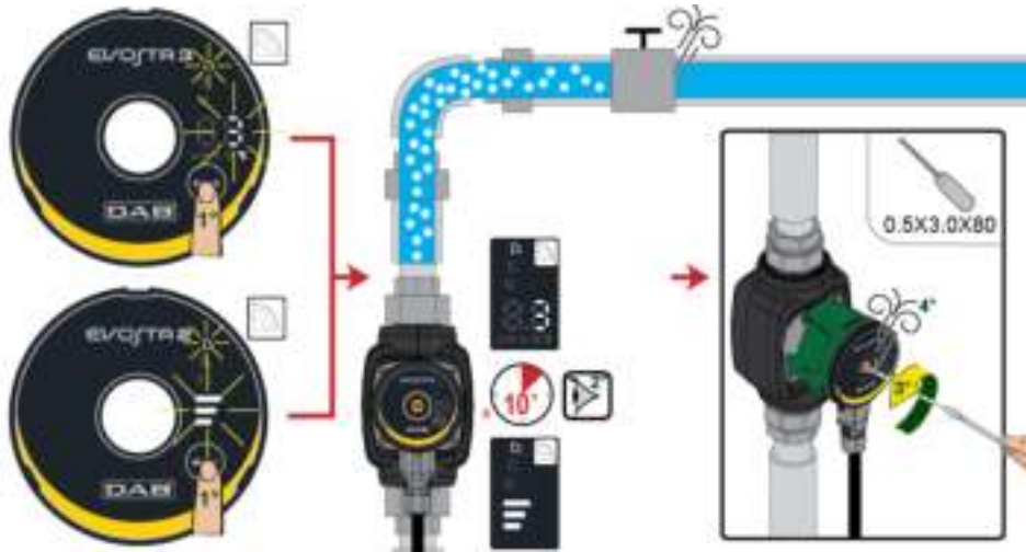
Εικόνα 8: Εξαέρωση της αντλίας
