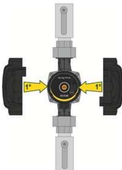
7 pav.: Siurblio korpuso izoliavimas
