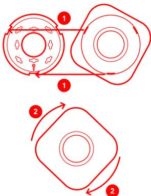
**Tip:** Als het nodig is de melders los te koppelen (om hem schoon te maken of de batterijen te vervangen), draai je de melder linksom totdat hij loskomt van de montagesteun.
