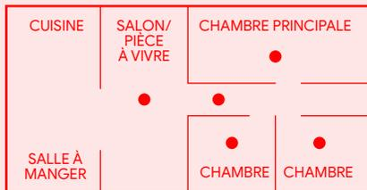
Nest Protect doit être installé à au moins 3 m des plaques ou appareils de cuisson.
