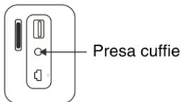
Tensione massima di uscita  $\leq 150\text{mV}$
