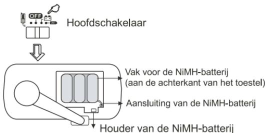
2. Het vak onder het toestel dient voor oplaadbare AAA-batterijen of alkalinebatterijen. Na de batterijen correct in het vak te hebben aangebracht, plaatst u de hoofdschakelaar op de stand
