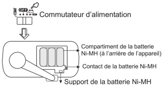
2. Le compartiment situé sous l'appareil est destiné aux piles alcalines ou rechargeables de type AAA. Après avoir inséré correctement les piles dans le compartiment, placez le commutateur d'alimentation sur la position
