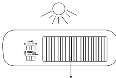
Zonnepaneel (bovenkant van het toestel)
