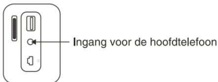
Maximale uitgangsspanning  $\leq 150\text{mV}$
