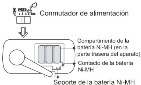
2. El compartimento de las pilas alcalinas o recargables de tipo AAA está situado en la parte inferior del aparato. Después de haber introducido correctamente las pilas en el compartimento, coloque el conmutador de alimentación en la posición
