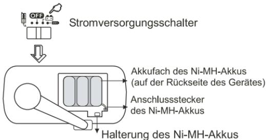
2. Das auf der Unterseite des Gerätes befindliche Batteriefach kann Alkalibatterien oder wiederaufladbare Batterien vom Typ AAA aufnehmen. Nach dem korrekten Einlegen der Batterien ins Batteriefach stellen Sie den Stromversorgungsschalter auf die Position
