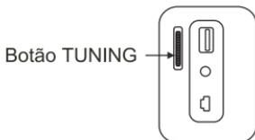
**Observação:** Para obter a melhor recepção durante a audição da banda FM, SW1 ou SW2, estique totalmente a antena telescópica, oriente o aparelho ou coloque-o na proximidade de uma janela. Durante a audição da banda MW, oriente o aparelho de forma a obter a melhor recepção possível.
