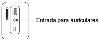
Voltaje máximo de salida  $\leq 150\text{mV}$
