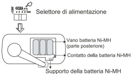
2. Il compartimento posto sotto l'apparecchio è destinato alle pile alcaline o ricaricabili di tipo AAA. Dopo aver inserito correttamente le pile nello scomparto, spostate il selettore di alimentazione in posizione
