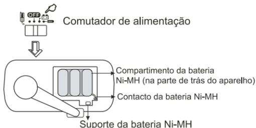
2. O compartimento situado na parte inferior do aparelho é destinado para pilhas alcalinas ou recarregáveis do tipo AAA. Depois de inserir correctamente as pilhas no compartimento, coloque o comutador de alimentação na posição
