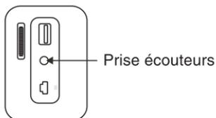
Tension de sortie maximum  $\leq 150\text{mV}$
