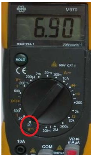
Zet de voltmeter op 20 V \overline{\text{---}}
