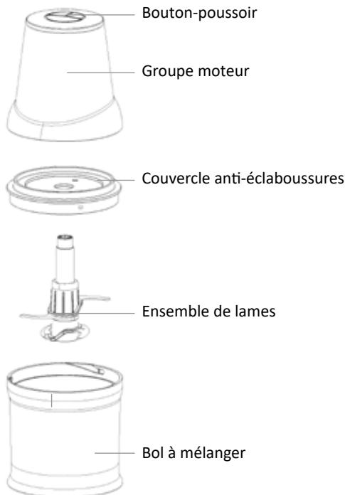
L'ensemble de lames se compose de deux éléments. Un élément de base avec deux lames et un élément supplémentaire contenant également deux lames. Vous pouvez faire glisser l'élément supplémentaire sur l'axe et le fixer sur l'élément de base. Vous avez ainsi 4 lames lorsque vous voulez hacher très fin. Voir l'illustration.
