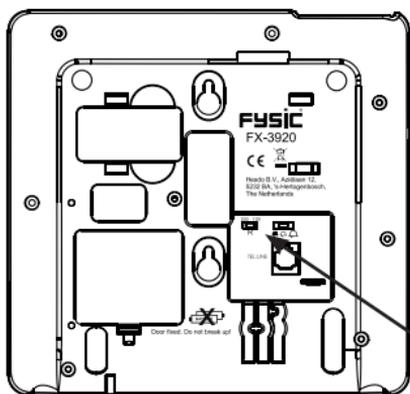
Die Unterseite des Telefons ist mit einem kleinen Schalter ausgestattet, um damit die Dauer der Unterbrechung einzustellen.
