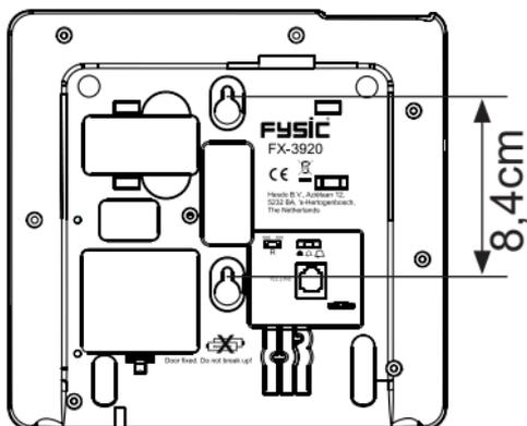
2. Schieben Sie die Hörerklammer aus dem Telefon, drehen Sie sie um 180° und legen sie wieder auf das Telefon; diese Klammer arretiert den Hörer bei Wandmontage.
