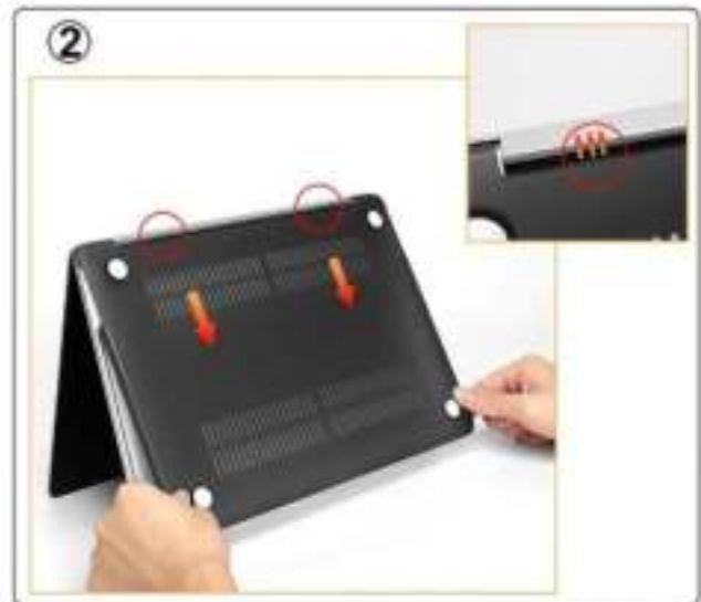
2. Bevestig eerst de bodem cover op de scharnierlocatie. Er zijn 2 clips om de achterkant van de onderkant vast te zetten
