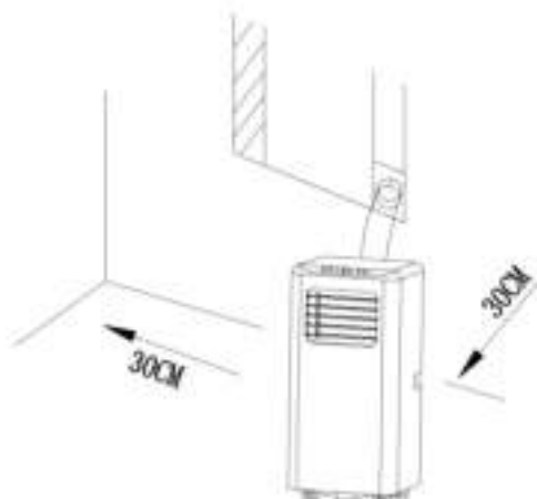
Afb. 7 Het apparaat plaatsen
