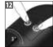
Aby opuściť tryb usuwania kamienia, naciśnij oba przyciski jednocześnie przez 3 sekundy. Ekspres jest teraz gotowy do użycia.
