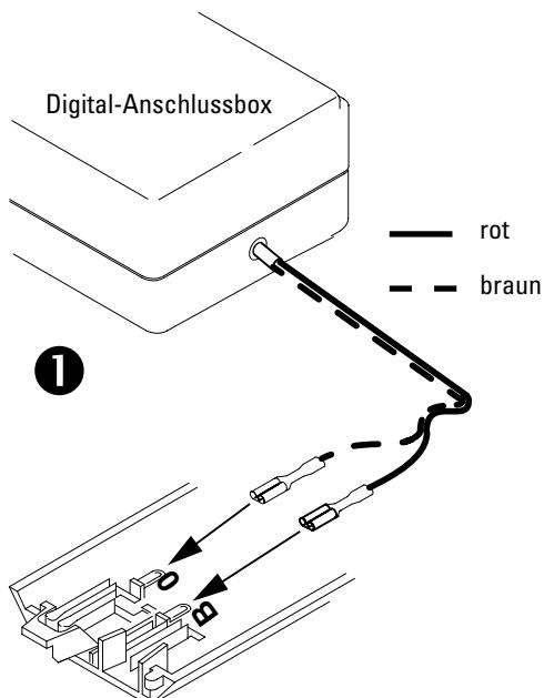
Nachdem die Digital-Anschlussbox angeschlossen ist, werden die Gleise entsprechend der nachfolgenden Skizze zusammen gefügt.
