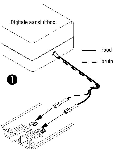
Nadat de digitale aansluitbox aangesloten is, worden de railstukken volgens onderstaande tekening aan elkaar gestoken.
