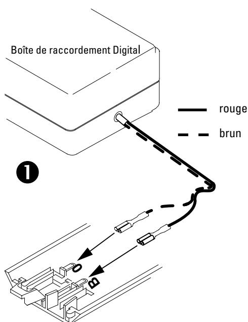
Une fois que vous avez branché la boîte de raccordement Digital, assemblez les voies en suivant le schéma suivant.
