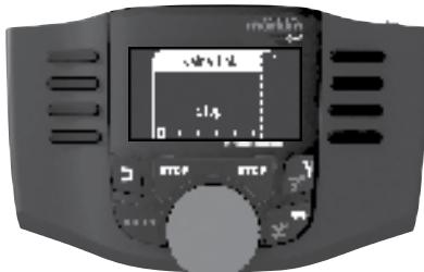
Posez la locomotive sur la voie, appuyez sur la touche Stop pour valider le circuit. Après quelques secondes, l'affichage indique mfx et clignote. Cela indique que le système a détecté la locomotive et que les données peuvent être lues.
