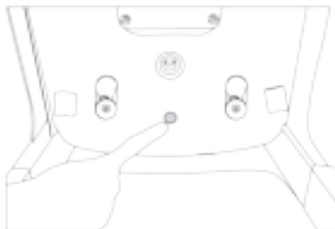
Afbeelding 1 b: Vergrendeld: de pin wordt teruggeduwd
