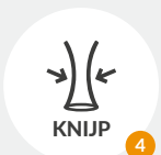
Kalkaanslag uit de nozzles verwijderen
