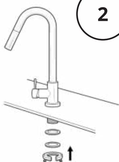
**NL)** Bevestig de koude en warme slang met de hand aan de kraan. Trek de slangen door het montagegat in de aangegeven richting.
