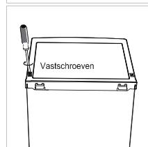
8. Remettez le panneau supérieur sur l'appareil et fixez-le avec 2 vis à l'arrière.
