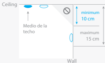
Figura 4 Ubicaciones óptima y aceptable de los detectores de humo
