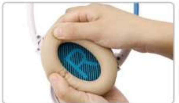
5. INSTALLEER HET NIEUWE OORKUSSEN DOOR HET IN ALLE PLASTIC HAKEN TE KLIKKEN
