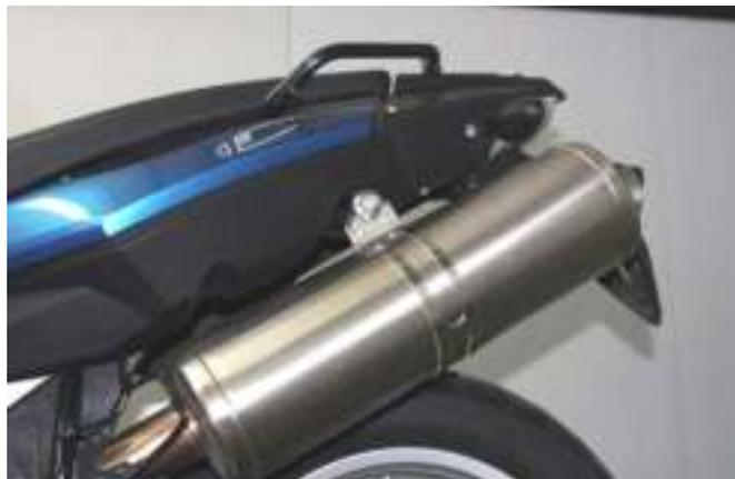
Svitare la vite di fissaggio del terminale e
