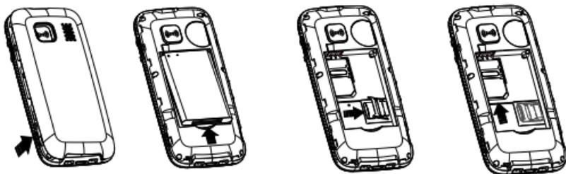
1. Entfernen Sie die Abdeckung des Akkufaches, indem Sie mit den Fingernägeln in die kleinen Aussparungen fahren, die sich unten seitlich am Mobiltelefon befinden und den Deckel nach oben abziehen.
