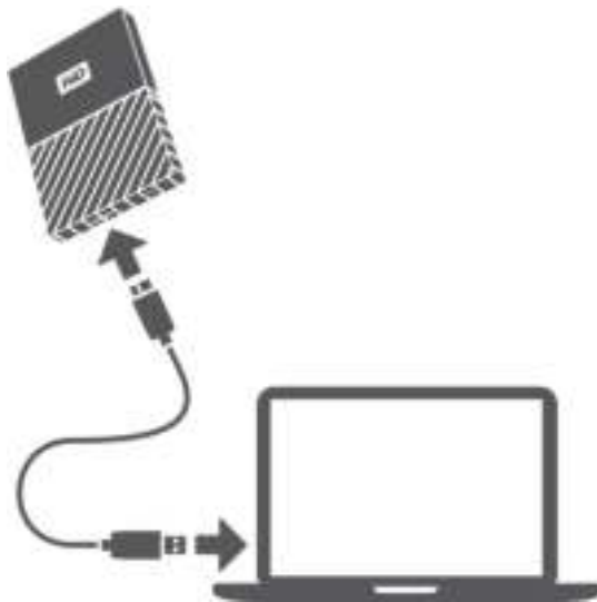
Afbeelding 3: Aansluiten van de My Passport-schijf
