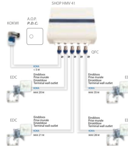
**NECESSAIRE DE CONNEXION POUR LES AMPLIFICATEURS CAI IN-HOME**
