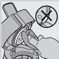
*Remarque : Faites attention à ne pas endommager la languette en métal sur le disque de distribution d'eau.*
