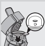
Die Maschine lässt sich nur entkalken, wenn der Deckel ordnungsgemäß geschlossen und der Verschlusshebel eingerastet ist. Ist dies nicht der Fall, blinkt der Leuchtring um den Ein-/Ausschalter.
