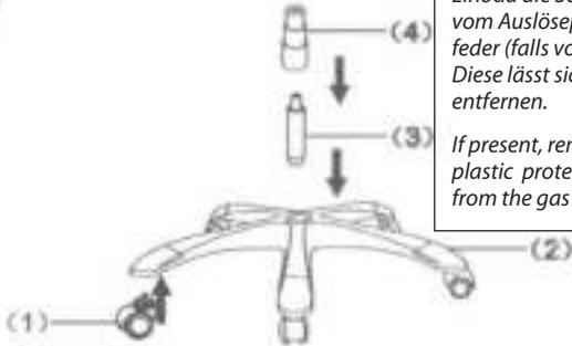
Entfernen Sie vor dem Einbau die Schutzkappe vom Auslöser der Gasfeder (falls vorhanden). Diese lässt sich leicht entfernen.
