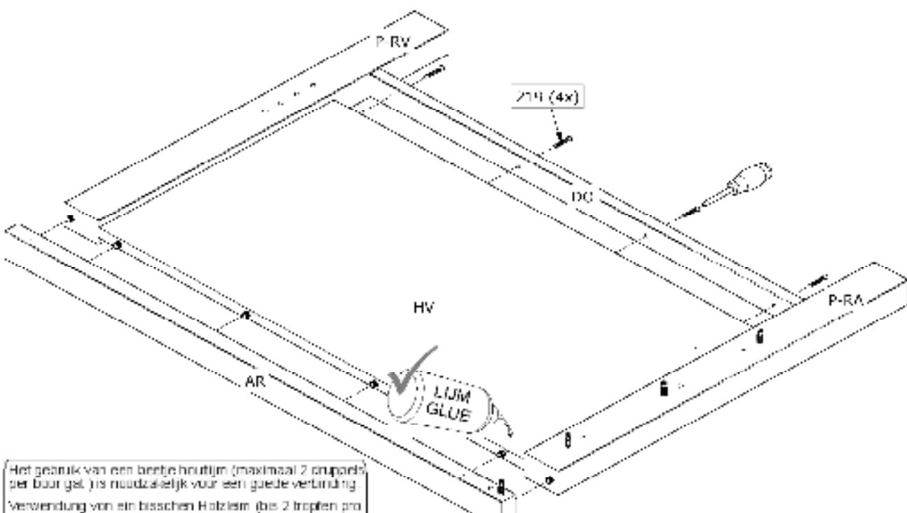
Het gebruik van een beetje houtlijm (maximaal 2 druppels) per boor gat is noodzakelijk voor een goede verbinding.
