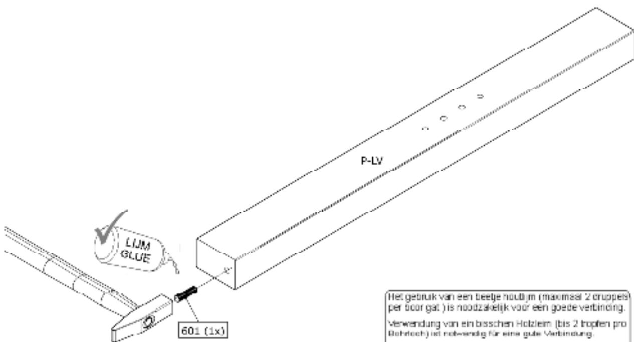
Het gebruik van een beetje houtlijm (maximaal 2 druppels per boor gat) is noodzakelijk voor een goede verbinding.
