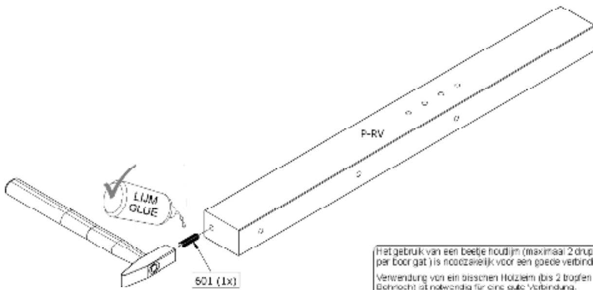
Het gebruik van een beetje houtlijm (maximaal 2 druppels per boor gat) is noodzakelijk voor een goede verbinding.
