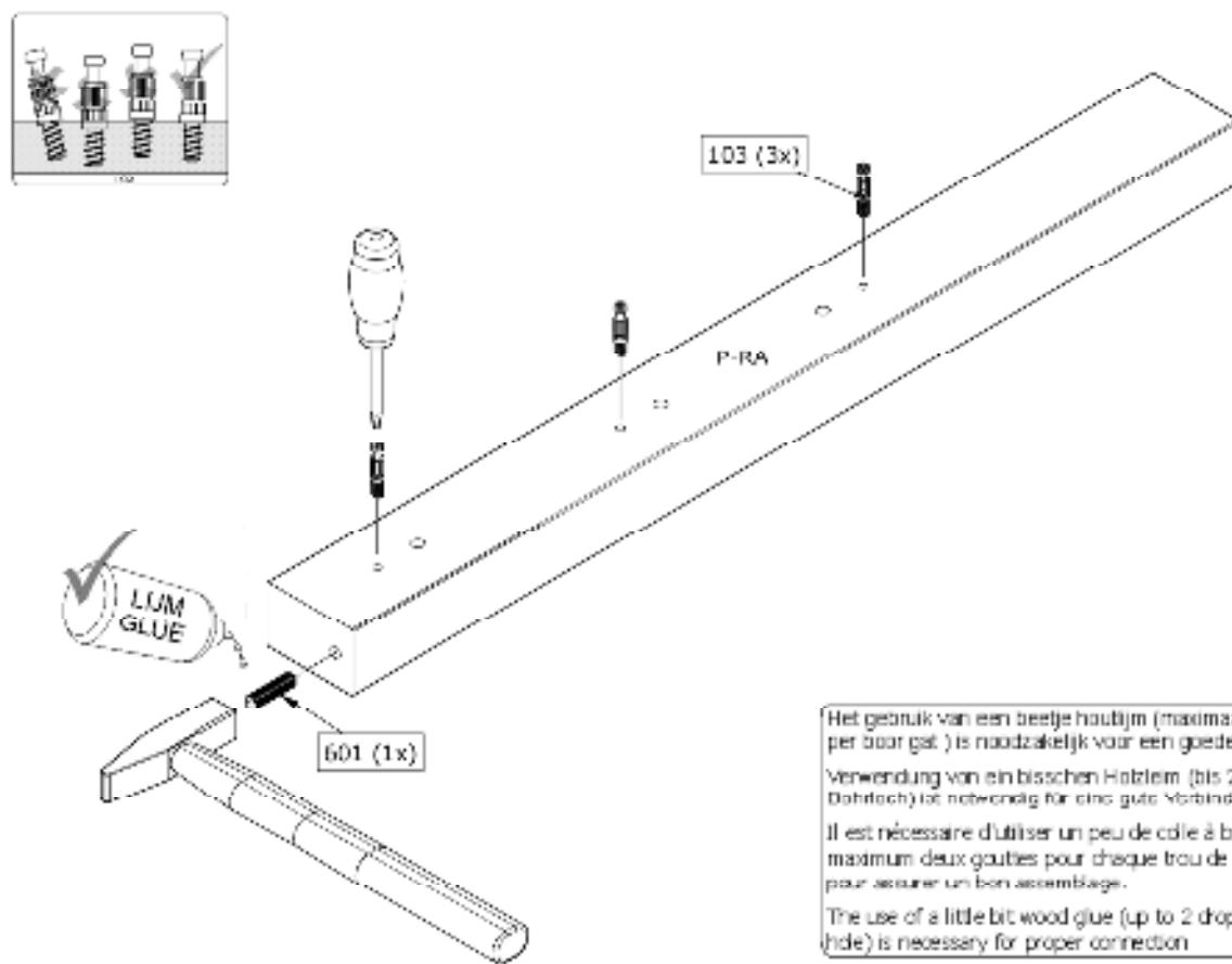
Het gebruik van een beetje houtlijm (maximaal 2 druppels per boor gat) is noodzakelijk voor een goede verbinding.
