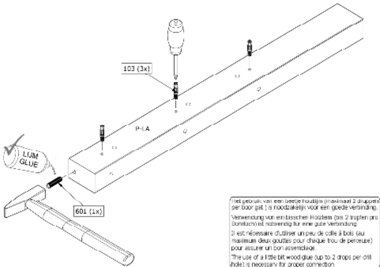
Het gebruik van een beetje houtlijm (maximaal 2 druppels per boor gat) is noodzakelijk voor een goede verbinding.
