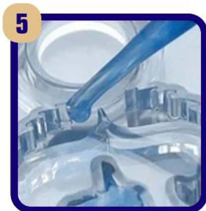
Giet langzaam in de mal met behulp van een druppelaar om luchtballen te voorkomen
