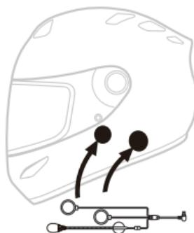
2.ヘッドセットをベルクロに取り付け、リングの位置に固定します。(短いコードスピーカーは左側にあります)
