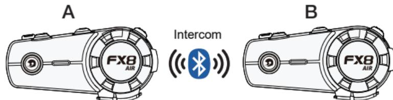
A FX8 AIRは検索モード(5.1.2を参照)、B FX8 AIRはペアリングモード(5.1.1を参照)にあり、A FX8 AIRとB FX8 AIRは赤と青のライトに交互に点滅する状態から、多機能ボタンとインターコムボタンが青のライトに同時に点滅する状態に変わると、正常に接続されたことになります。
