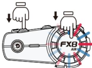
ペアリングメモリをクリアする:FX8 AIRは他のデバイスとのペアリングメモリを手動でクリアできます。デバイスがスタンバイ状態で、「多機能」ボタンと「前」ボタンを同時に約5秒間押すと、赤と青のライトが同時に点滅し、ペアリングメモリのクリアが完了します。(「ドゥー、ドゥー、ドゥー」という音声メッセージが表示されます)
