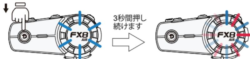
デバイスがオンの状態で、インターコムボタンを約6秒間を長押しし、赤と青のインジケータライトがゆっくり点滅し、検索モードに入り、音声メッセージ「ドゥー」が聞こえます。検索モード機能はFX8 AIRデバイス間に適用されます。
