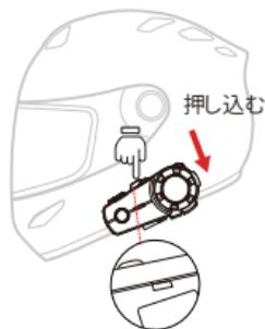
3. インカム本体を取り付ける:ホストの下部にある隆起したバックルをベースの溝に挿入してください。ベースの上のバックルがホストの上の溝にバックルするように、ホストをベースに押し込んでください。
