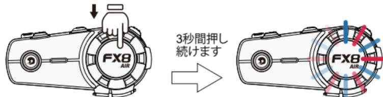
ステップ2. 携帯電話のBluetoothをオンにし、「FX8 AIR」を選択し、ペアリングが完了します。「デバイスの接続に成功しました」という音声メッセージを通知します。
