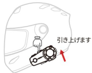
2. 上部のベースバックルを押して、デバイスを上に移動させ、取り外します。
