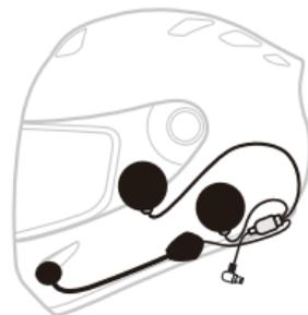
3.ヘルメットの左側のマイクとマジックテープを適切な位置を固定し、マイクが口のほうを向くよう、内装後ろ側に配線を通します。
