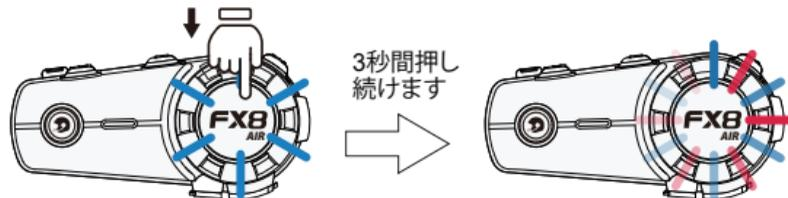
デバイスがオンの状態で、多機能ボタンを約6秒間長押しし、赤と青のライトが素早く点滅し、ペアリングモードに入り、音声メッセージ「ドゥー、ドゥー」が聞こえます。ペアリングモードは携帯電話やGPSなどのBluetoothデバイスに接続することに適用されます。
